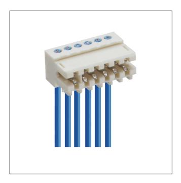
RAST-2.5-Steckverbinder für direktes Stecken, in Schneidklemmtechnik (SKT), mit Verrastung auf der Leiterplatte durch Rastnocken, wahlweise mit oder ohne Kodiersteg und geschlossenen Seitenwänden, für Einzelleiter, busfähig Kontaktraster 2,5 mm
